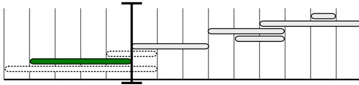
Gambar 6.7: Langkah 2: Setelah memilih  $\langle 2,6 \rangle$ , kita dapatkan subpersoalan dengan pilihan yang tersedia berupa:  $\langle 6,9 \rangle$ ,  $\langle 9,12 \rangle$ ,  $\langle 10,12 \rangle$ ,  $\langle 11,15 \rangle$ ,  $\langle 13,14 \rangle$ .
