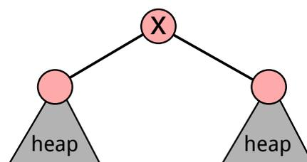
Gambar 10.18: Operasi *heapify* hanya dapat bekerja apabila *subtree* kiri dan *subtree* kanan dari *root* telah membentuk *heap*.
