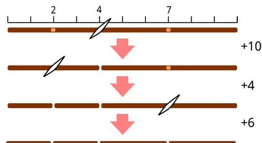
Gambar 7.4: Langkah pemotongan kayu yang lebih optimal.
