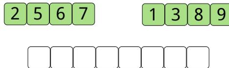
Gambar 5.9: Diberikan 2 buah *array* yang sudah terurut, kita ingin menggabungkannya menjadi satu *array* yang terurut.
