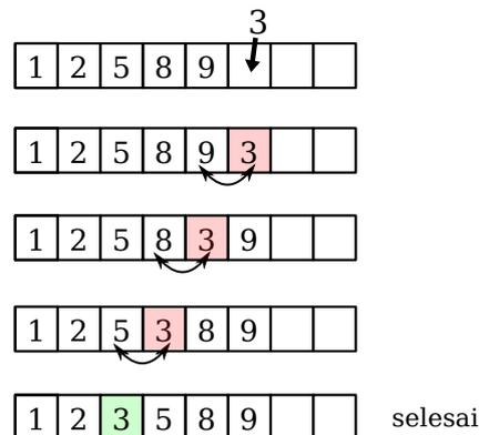
Gambar 3.11: Ilustrasi penyisipan angka 3 pada data [1, 2, 5, 8, 9].
