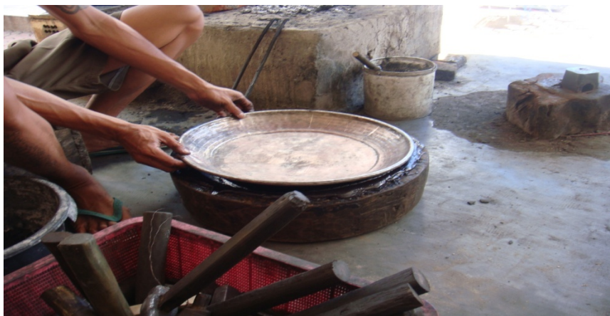
Gambar 5 Proses Penempatan Perak Lempengan ke Dalam Cetakan yang Siap di Desain dan di Ukir
