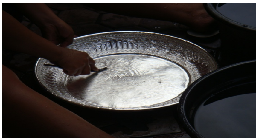
Gambar 8 Proses Pembersihan Produk yang Dihasilkan dengan Air dan Buah Asem
