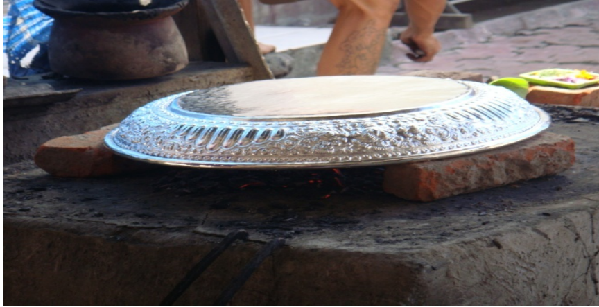
Gambar 9 Proses Pengeringan Produk yang Telah Dihasilkan di Tungku Perapian
